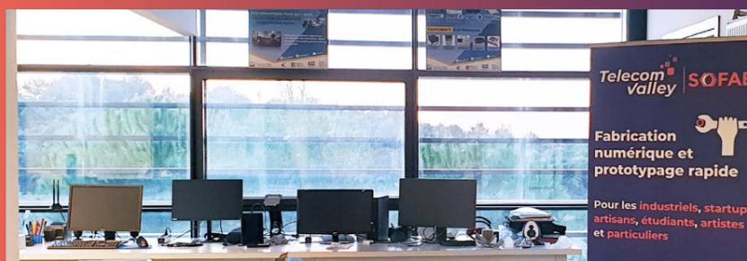
**LE BANC D'ÉLECTRONIQUE** est repositionné dans l'espace de prototypage pour être plus accessible, mieux équipé et mettre en valeur les appareils (soudure, brasure, mesures).
