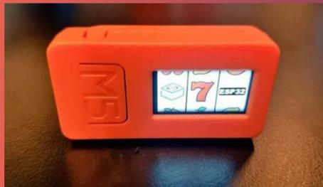
Le M5 Stick est un mini ordinateur qui embarque le Bluetooth, le Wi-Fi, de l'infrarouge, une led, deux boutons et même un micro. La formation propose d'apprendre à assembler des briques prédéfinies pour un mini projet d'arrosage automatique.
