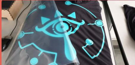
Formation sur notre nouvelle machine ROLAND BN-20 imprimante couleur et plotter de découpe pour réaliser un transfert thermique pour T-shirt grâce à notre presse numérique.
