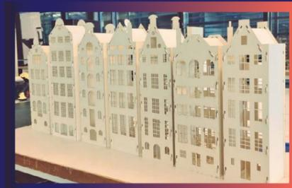
La découpe et la gravure laser sont très accessibles grâce à la Trotec Speedy 100, un incontournable des FabLabs français : avec un logiciel de dessin vectoriel, cela suffit à définir par le tracé et quelques couleurs spécifiques ce que l'on souhaite réaliser.
